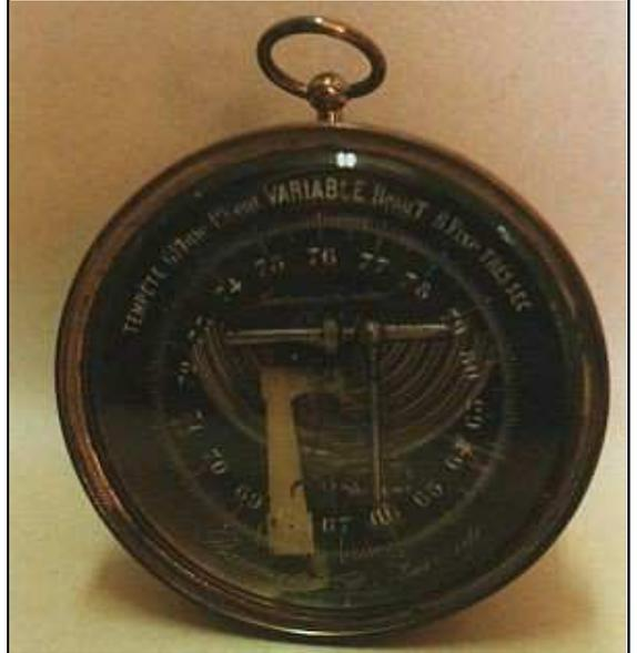
4. Baromètre métallique
